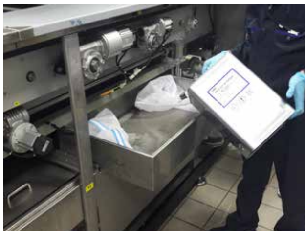
Przyjazny dla operatora system wysuwanych zbiorników z łatwym dostępem.
