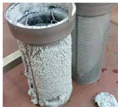
Wkłady filtracyjne umożliwiają łatwe usuwanie odpadów polimerowych
