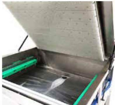
System wymywania z płaskimi szczotkami
