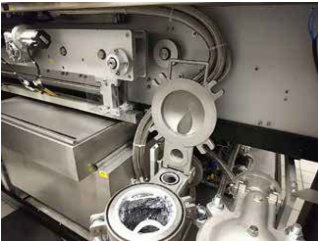
Komponenty maszyny ze stali nierdzewnej z wysuwanym zespołem filtrującym.
