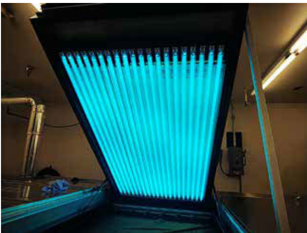
Sekcja doświetlania końcowego UV w linii zapewnia wysoką jednorodność płyt.
