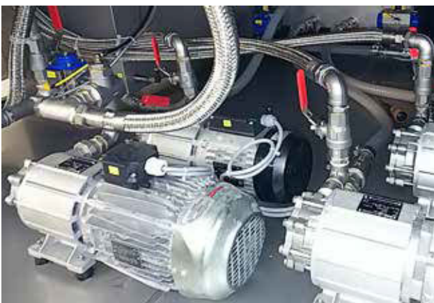
Magnetyczne pompy ze stali nierdzewnej ułatwiają konserwację. Pompy tego typu nie są wyposażone w uszczelki – nie ma problemu z wyciekaniem wody.
